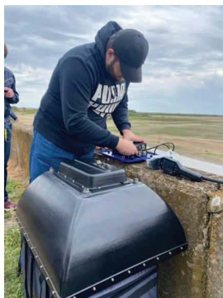
Рисунок 5. Антенный блок георадара ОКО-3 АБ-400РЗ и пример, как при помощи измерительной рулетки намечались места для дальнейших, более детальных георадарных обследований Figure 5. The antenna unit of the GPR OKO-3 AB-400R 3 and an example of how, with the help of a measuring tape places were planned for further, more detailed GPR surveys
