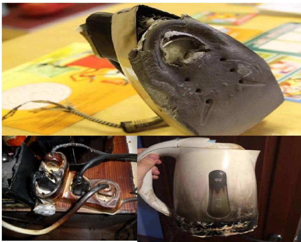
Рисунок 2 – Аварийные ситуаций при нарушении эксплуатации электрооборудования
