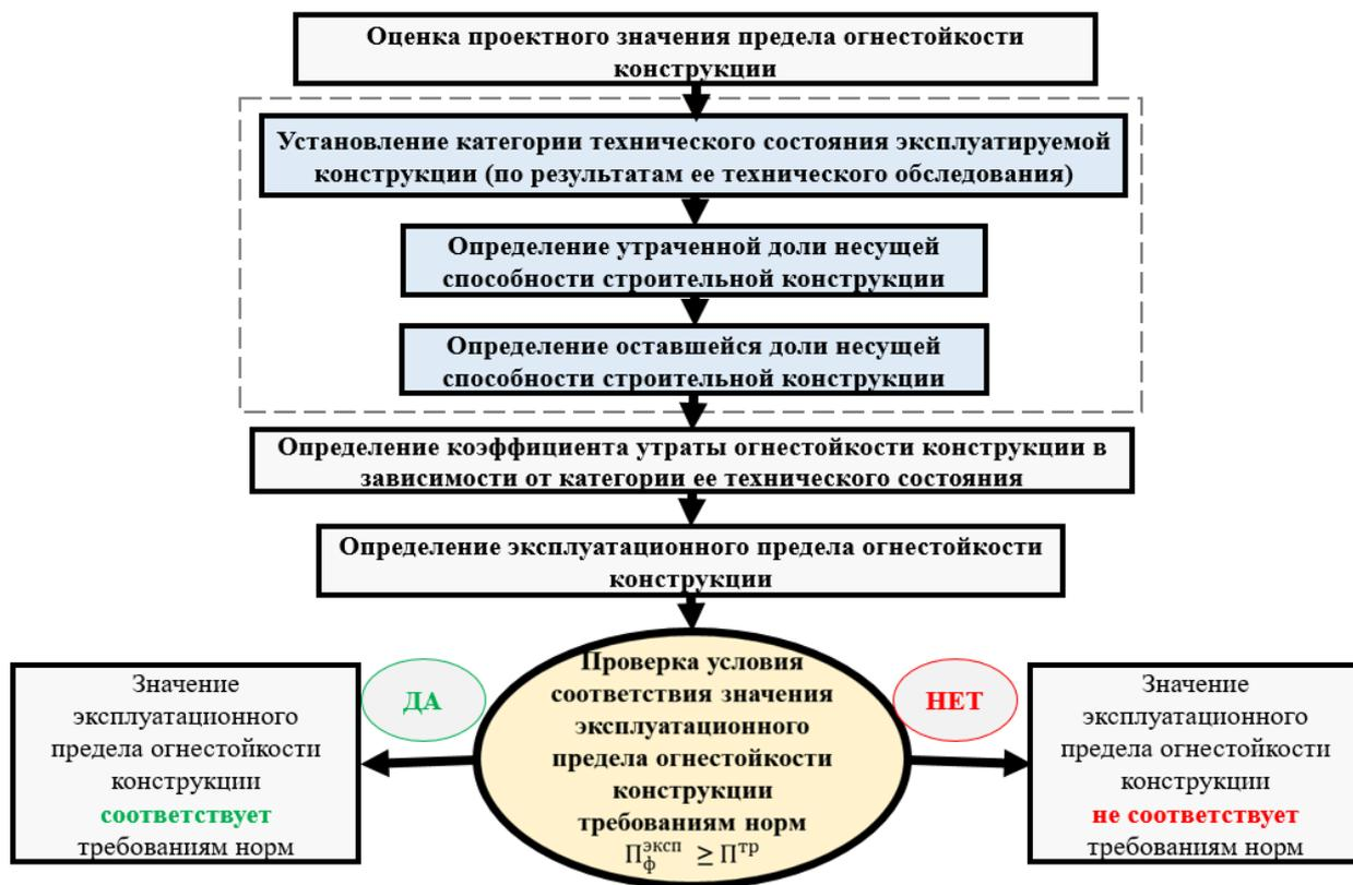
Рисунок 1. Общая схема метода оценки эксплуатационных пределов огнестойкости строительных конструкций (на примере металлической конструкции) с учетом их технического состояния в условиях эксплуатации
