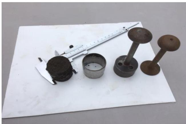
Рисунок 1 - Прибор для отбора образцов на плотность почв (режущее кольцо) возле дерева (пример нетронутой человеком почвы) в трехкратной повторности на глубине 5-10см.
