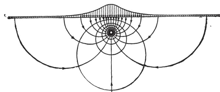
Рисунок 2. Иллюстрация притока болотной воды к горизонтальной дрени
