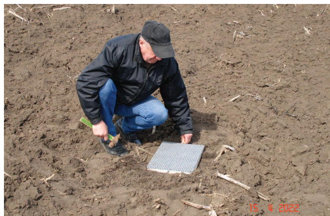
Рисунок 2. Размещение ворсистых пластиковых матов на стационарном участке наблюдений перед началом весеннего половодья Figure 2. Placement of fleecy plastic mats at a stationary observation site before the onset of spring floods
