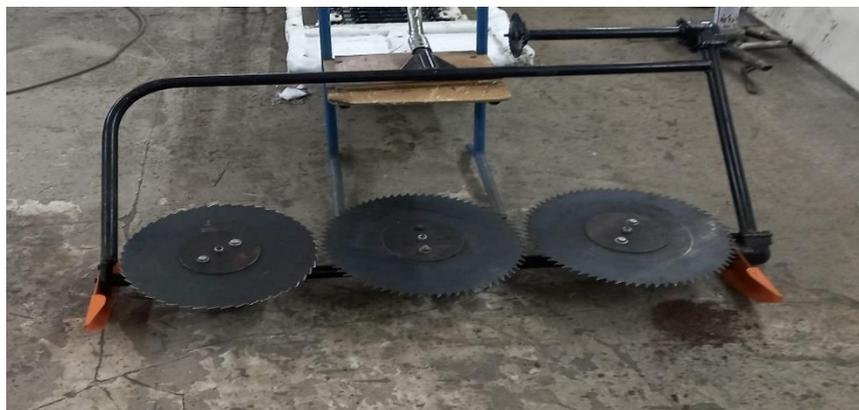
Рисунок 8. Режущие диски после монтажа
