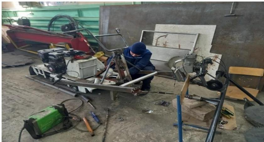
Рисунок 10. Процесс сборки рамы на мото-буксировщик
