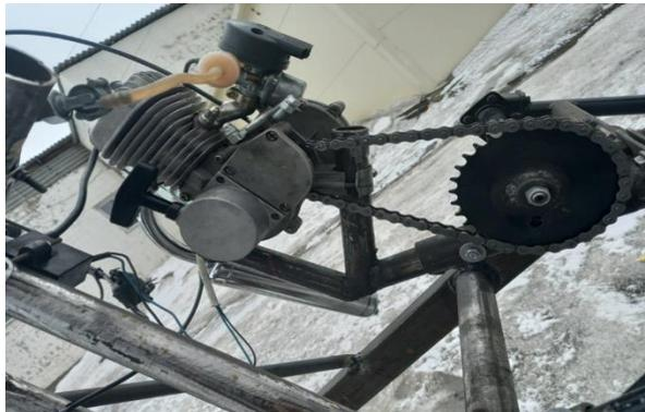
Рисунок 9. Двигатель Ф-80 с установленной рамой
