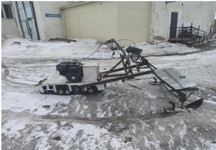
Рисунок 14. Готовая камышекосилка
