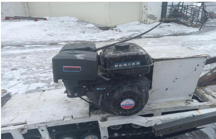
Рисунок 13. Двигатель Лифан 182 F смонтированный на шасси
