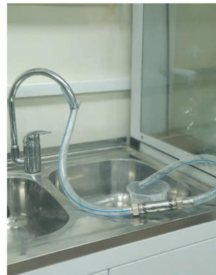
Рисунок 2. Вид АМП — 15РЦМ подключенного к водопроводному крану (2022)
