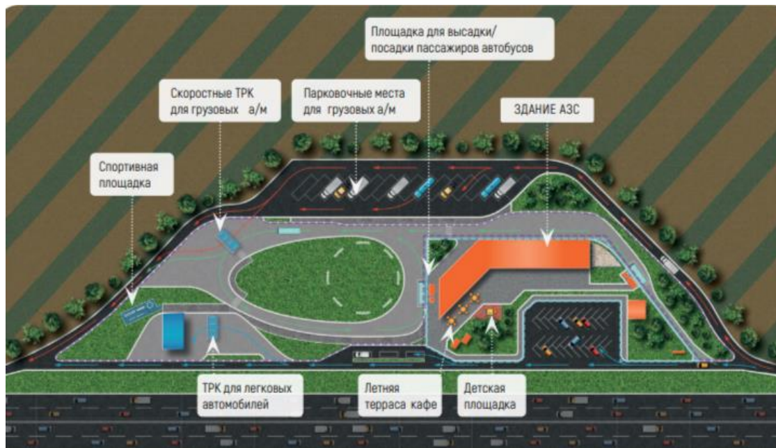
Рисунок 9 – Примерная схема размещения ОДС В МФЗ (3д модель)
