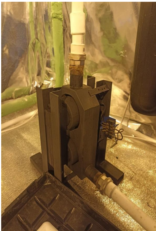
Рисунок 9. Индуктивно-кондуктивный нагреватель мощностью 1 кВт, с напряжением 220 В. Водяной контур находится между двумя катушками
