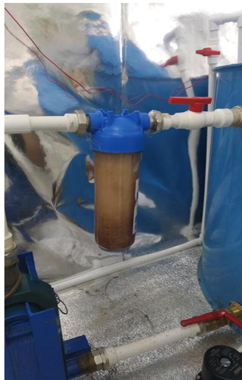
Рисунок 9. Индуктивно-кондуктивный нагреватель мощностью 1 кВт, с напряжением 220 В. Водяной контур находится между двумя катушками
