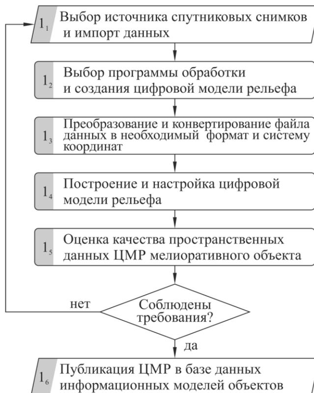
Рисунок 1. Предлагаемый алгоритм создания цифровой модели рельефа
