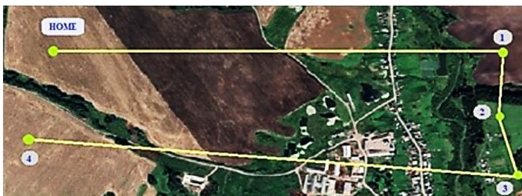
Рисунок 7 – Маршрут аэрофотосъемки площадного объекта
