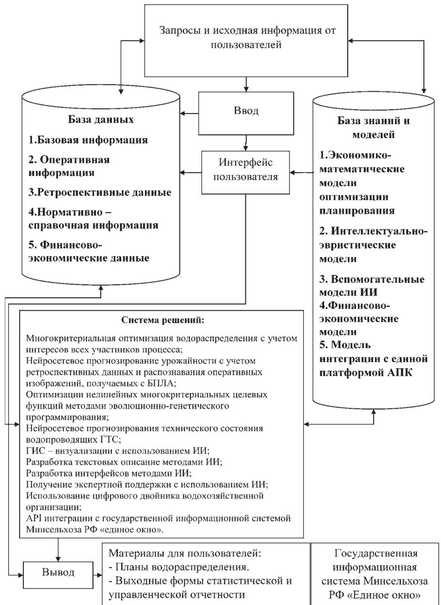
Рисунок 1. Структурно-функциональная схема автоматизированной системы
