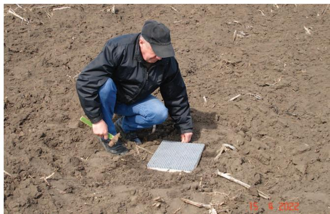
Рисунок 2. Размещение ворсистых пластиковых матов на стационарном участке наблюдений перед началом весеннего половодья
