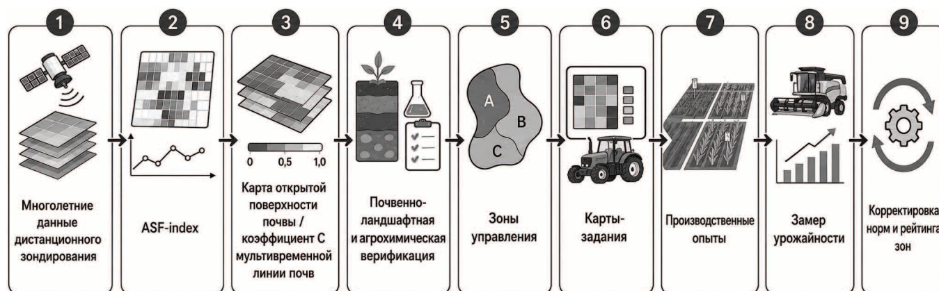
Рисунок 1. Концептуальная схема выделения устойчивых внутриполевых зон управления для точного управления производственным процессом Figure 1. Conceptual scheme for delineating stable within-field management zones for precision crop production management
