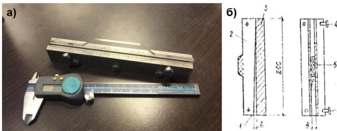
Рисунок 2. Фото (а) и эскиз прибора для определения литейной способности шликера ПЛС-1 (б); 1 – рабочий канал, 2 - вкладыш из органического стекла, 3 – стальной корпус, 4 – стальные штифты, 5 – шкала.[1]
