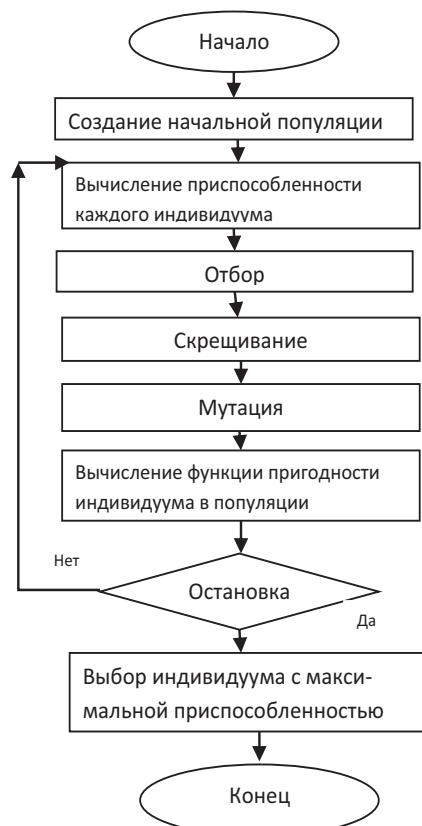
Рисунок 1. Структурная схема генетического алгоритма [15]
