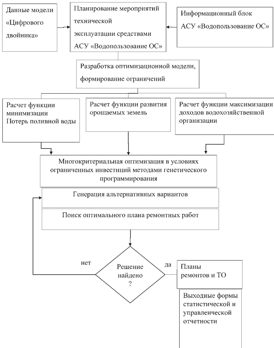
Рисунок 3. Алгоритм планирования мероприятий технической эксплуатации Figure 3. Algorithm for planning technical operation activities
